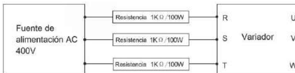
Ilustración de la carga a 400V de los condensadores de un variador
